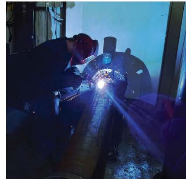
5. Сварка в сварочном вращателе
